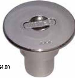
Aus verchromtem Messing. Lassen sich ohne Schlüssel oder Werkzeug öffnen. Der Deckel verdeckt den Flansch vollständig. Außen-Ø 88 mm, für Schlauchanschlüsse von 38 mm.
