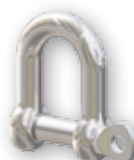
Art. 540085S 8mm D-Schäkel (AISI 316) Für 2- und 3-Scheiben Blöcke Gewicht = 62gr SWL = 1300kg
