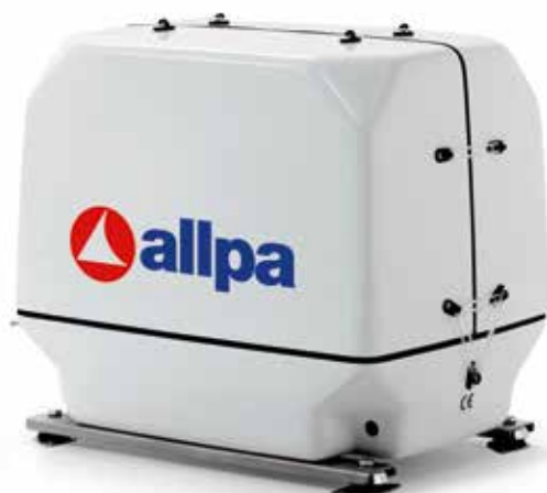
Paguro 14000 Art. G14100 Elektrische Dauerleistung 14 KVA – 11kW Gewicht (Inkl. Schallhaube) = 210kg Abm. 860x580x650mm (LxBxH)
