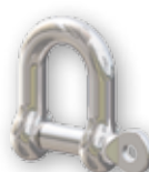
Art. 540065S 6 mm D-Schäkel (AISI 316) Für 1-Scheiben Blöcke Gewicht = 26gr SWL = 800kg
